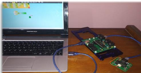
Imagen 5. La placa USB4Butiá conectada a la computadora
