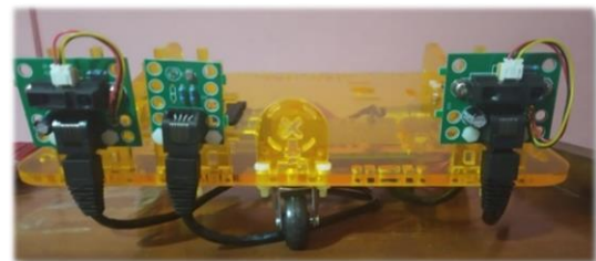
Imagen 11. Dos sensores distancias en los costados, y un sensor de luz en el medio.
