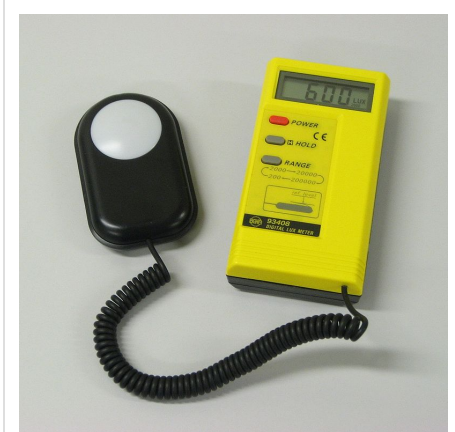
Fotómetro para medir la iluminancia en lugares de trabajo.
