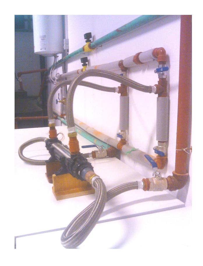
En el primer curso de Transferencia de calor se realiza un ensayo que permiten calcular la difusividad térmica del cobre, y otro en el que se estiman coeficientes de convección en distintos medios y se analiza un proceso de enfriamiento transitorio
