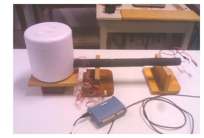
Para el segundo curso, se acondicionó una práctica que permite estimar la constante de radiación de Steffan-Boltzman, a partir de un calculo numérico del factor de vista de un filamento y de medidas experimentales.
