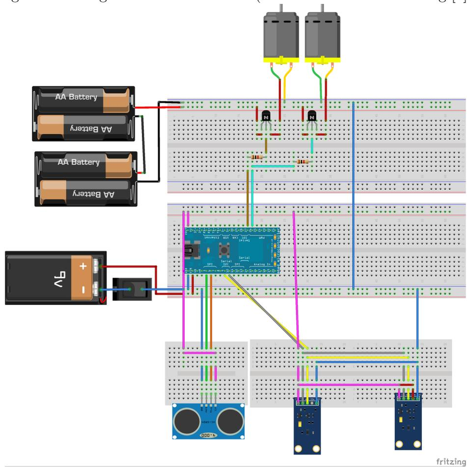
El diagrama muestra los componentes físicos que son montados en el robot para resolver el problema y cómo se interconectan. Arriba se pueden ver los dos motores, que irán uno a cada lado del robot y sólo se moverán hacia
