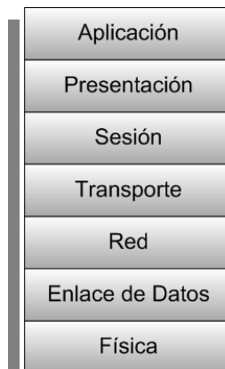
Ilustración 1: Capas del modelo OSI
