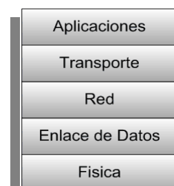
Ilustración 2: Capas del modelo TCP/IP
