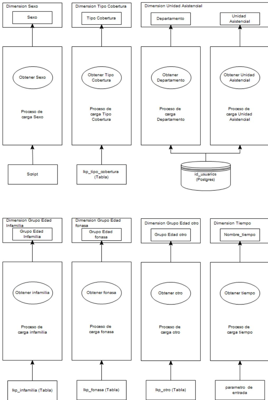
Figura 5.6: Diagrama de cargas de dimensiones
