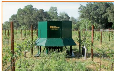
*“SUMIDERO INVERTIDO SELECTIVO” del uruguayo Dr Ing Rafael Guarga Pat No 13387 de 1991 que es un dispositivo para combatir la helada de radiación, que en invierno destruye los cultivos de uvas y cítricos. Mediante un ventilador de eje vertical se realiza un drenaje forzado de las capas de aire frío que se instalan cerca del suelo. Está patentado en Estados Unidos con la Pat No5647165 desde 1997.*
