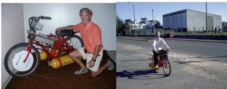
*"Motor de gas a pistón, cadena y piñón" del uruguayo Armando Regusci que posee la Patente de invención No 13197 de 1990. La creación consiste en un motor de aire u otro gas que permite usar la energía del aire u otro gas que al descomprimirse la transforma en energía mecánica para mover un vehículo como ser una bicicleta, un auto, ómnibus, etc.*
