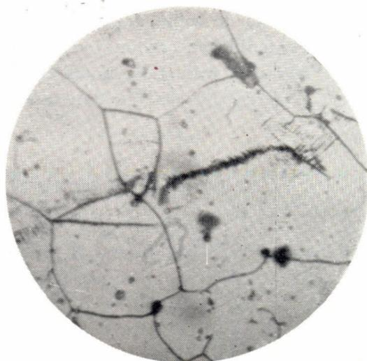
Figs. 4, 5 y 6. - Fotomicrografías demostrativas del ataque intergranular; 2 horas a 600°C; aumento: 700  $\times$  (Instituto de Ensayo de Materiales)
