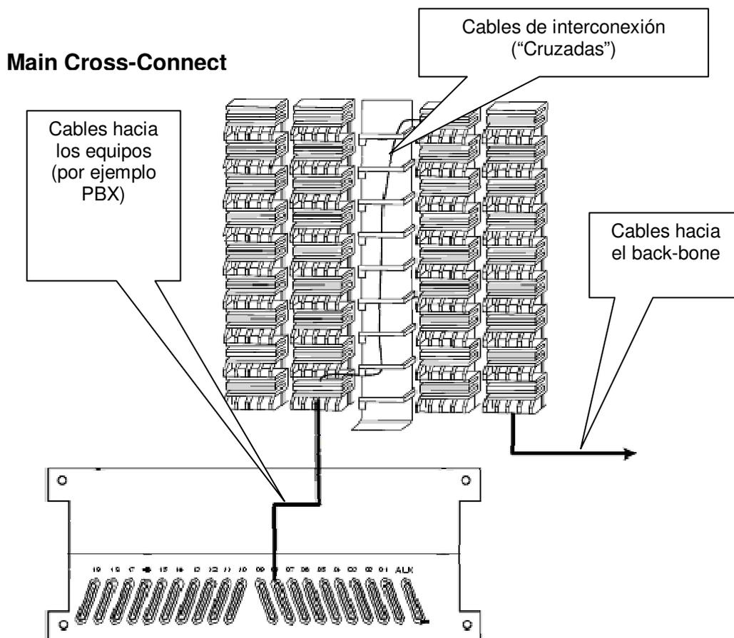
En la figura se muestra un distribuidor principal realizado con "regletas", al que llegan los cables desde los equipos centrales (por ejemplo, desde una PBX) y del que salen los "cables montantes" o cables de back-bone.
