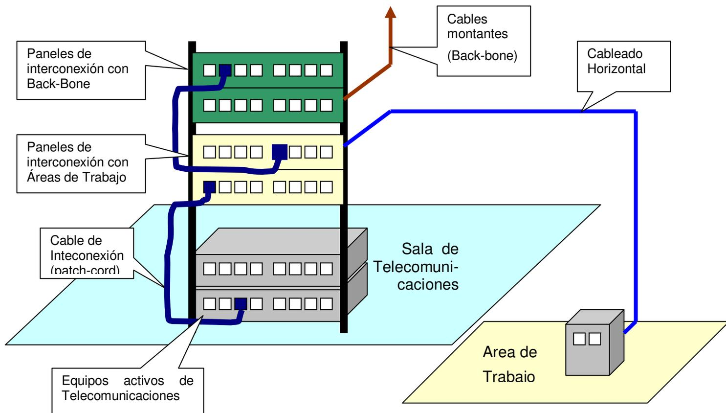
Típicamente los repartidores horizontales, ubicados en las salas de telecomunicaciones, consisten en “paneles de interconexión”, en los que terminan los cableados horizontales y los cableados de backbone. Estos paneles de interconexión permiten, mediante el uso de “cables de interconexión”, conectar cualquier cable horizontal con cualquier cable de backbone o equipo activo.
