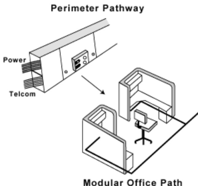
Los ductos perimetrales pueden ser usados para llegar con el cableado horizontal hasta las áreas de trabajo, en caso de oficinas cerradas o tipo “boxes”.
