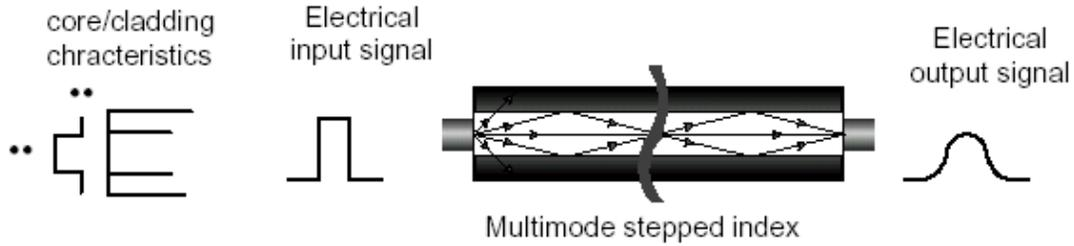
Es de notar que en este tipo de fibras, la luz puede transitar por caminos de distinta longitud total (de acuerdo a cada uno de los “modos”). La velocidad de propagación de la luz dentro del núcleo está dada por
