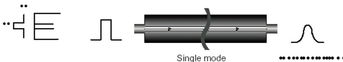
Las fibras monomodo comerciales tienen diámetros de 9/125  $\mu\text{m}$ . Las ventanas utilizadas son las de 1300 nm y 1550 nm, con emisores del tipo LASER.
