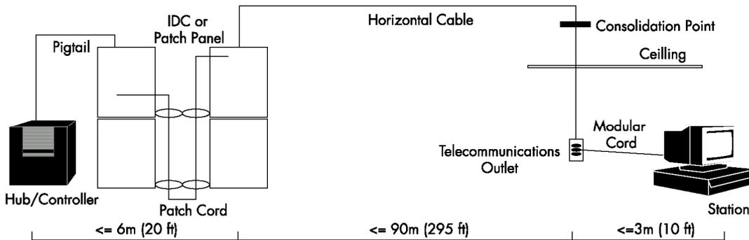
Los “puntos de Consolidación” son lugares de interconexión entre cableado horizontal proveniente del repartidor horizontal y cableado horizontal que termina en las áreas de trabajo o en los “Dispositivo de múltiples conectores de telecomunicaciones”.
