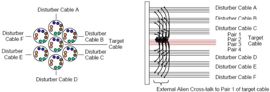
Se introducen para estas aplicaciones los parámetros “Power Sum Alien Near-End Crosstalk” (PSANEXT) y “Power Sum Alien Far-End Crosstalk” (PSAFEXT), los que tienen en cuenta la interferencia de cables cercanos sobre cada cable, típicamente en una distribución en la que 6 cables UTP rodean a un cable.
