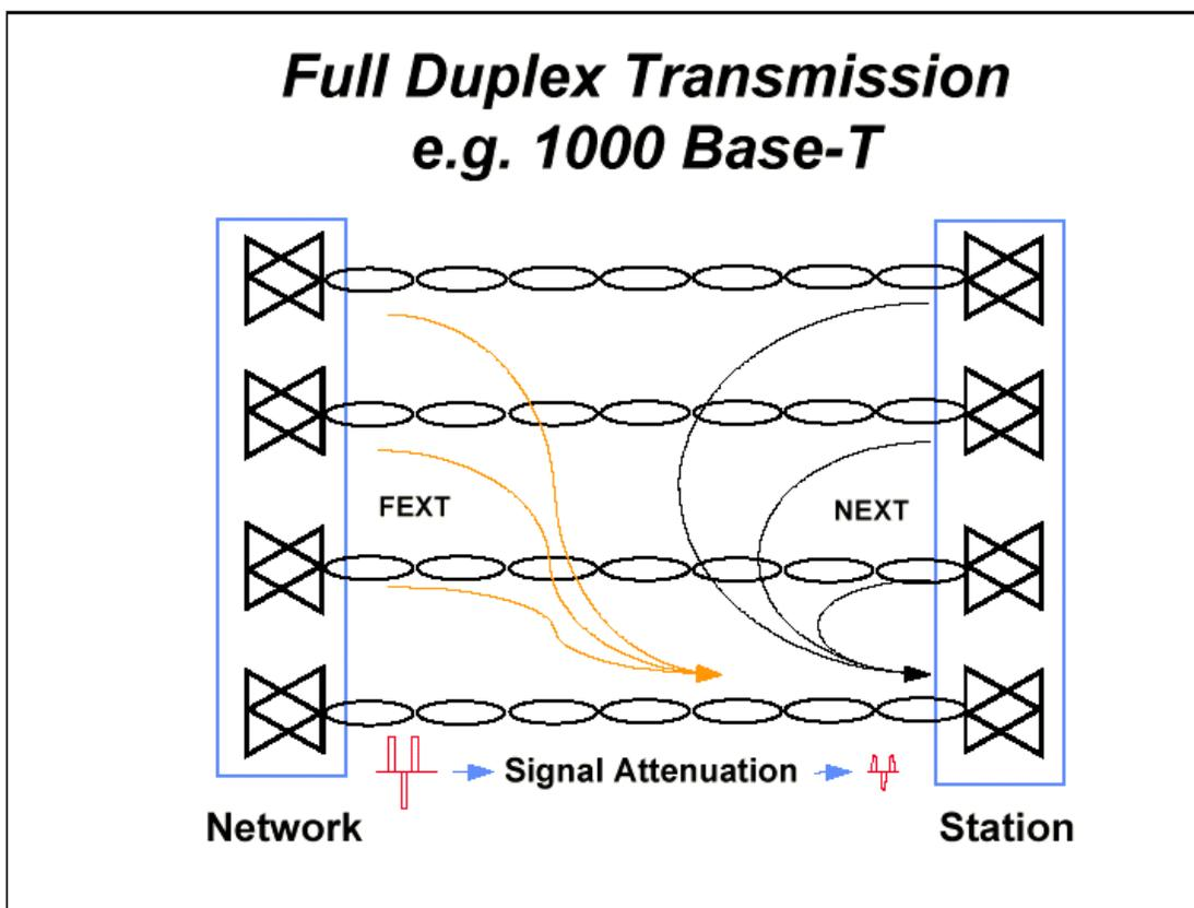
En la categoría 6A y en la actual TSB-155 se indica que es necesario medir no solo el Cross Talk producido por pares dentro del mismo cable, sino también por los pares de cables cercanos. En aplicaciones de 10GBase-T, con anchos de banda de hasta 500 MHz, este tipo de interferencias no puede despreciarse, y es denominada “Alien Cross Talk” (AXT), como se simboliza en las siguientes figuras [6]
