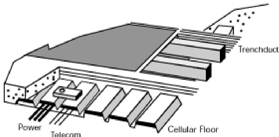
En estos casos los ductos son parte de la obra civil. Bajo el piso se puede realizar una “malla” de ductos, disponiendo de líneas determinadas para telecomunicaciones, energía, etc. En las áreas de trabajo se dispone de puntos de acceso a los ductos bajo piso, utilizando “torretas”, “periscopios” u otro tipo de accesorios.
