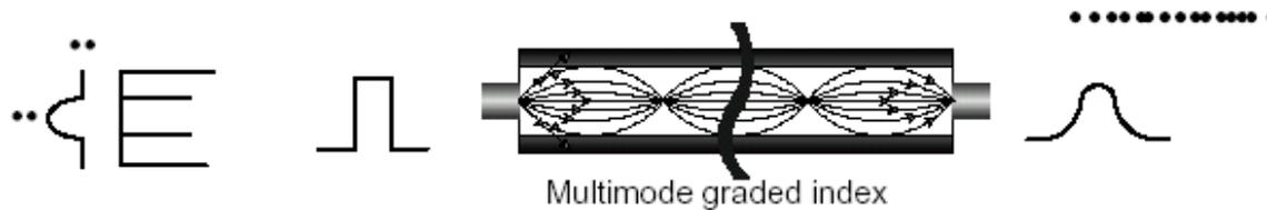
Las fibras multimodo comerciales se conocen generalmente por el diámetro del núcleo y el cladding. Las más comunes son 50/125 μm y 62.5/125 μm. Las ventanas utilizadas en las fibras multimodo son las de 850 nm y 1300 nm, con emisores del tipo LED.
