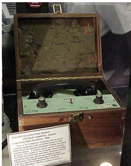
Izquierda: Uno de los primeros módems de acoplamiento acústico, fabricado en 1968 [205].
