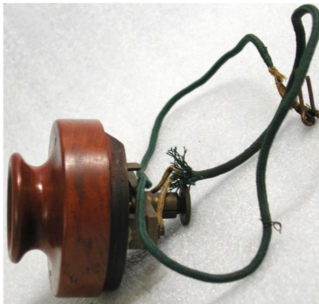
Izquierda: Diagrama del dispositivo presentado por Edison en su patente [31]. Derecha: Foto del primer micrófono/parlante diseñado por Edison [42].
