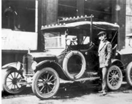
El patrullero y operador de radio Walter Stick junto a uno de los primeros autos de policía comandados por radio, un Ford-T. Observe las antenas en el techo del auto [102].
