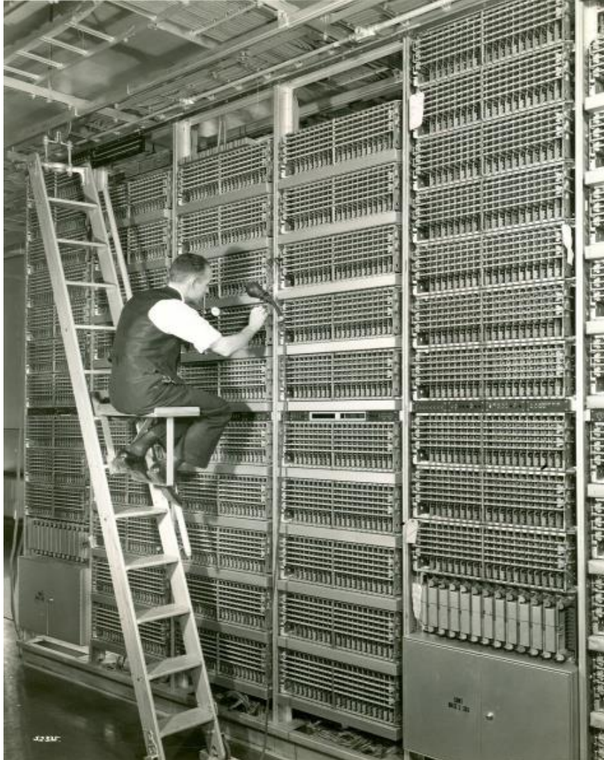
Sistema Crossbar #1, Nueva York, 1938. Cada gabinete contiene 20 unidades de conmutación de barras transversal. Estas unidades contienen relés electromecánicos que no requieren grandes movimientos mecánicos. Los únicos movimientos mecánicos son para la apertura y el cierre de los relés [120].
