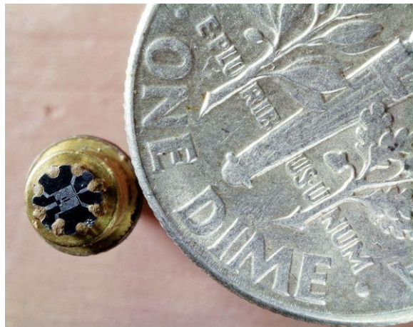
Primer circuito integrado con tecnología monolítica plana, según el diseño de Rober Noyce [184]
