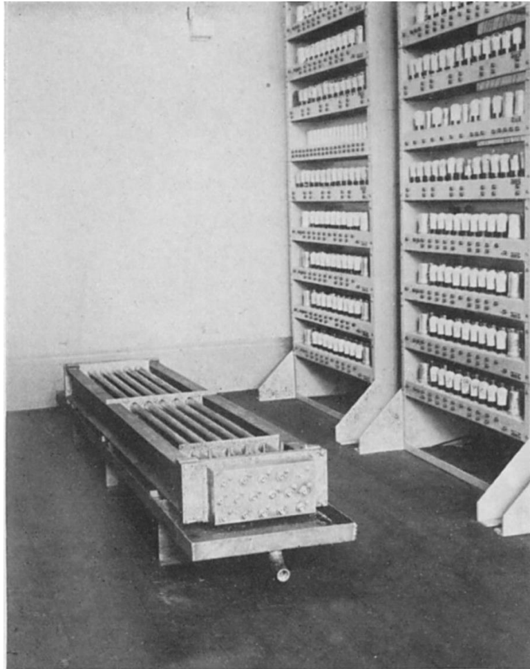
Banco de dieciséis líneas de retardo usadas como memoria temporal, junto con parte de su equipamiento asociado, utilizadas en EDSAC
