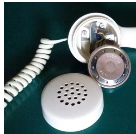
Izquierda: Diagrama de un micrófono de carbón utilizado entre 1950-1990. Derecha: Micrófono de carbón de un teléfono de 1980.
