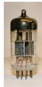
Izquierda: Esquema del funcionamiento de un triodo. Derecha: V3lvula comercial modelo 12AU7, del tipo “Doble Triodo” de 1955.
