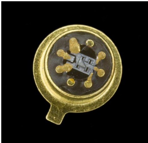
Primer circuito integrado con tecnología monolítica plana, según el diseño de Rober Noyce [184]
