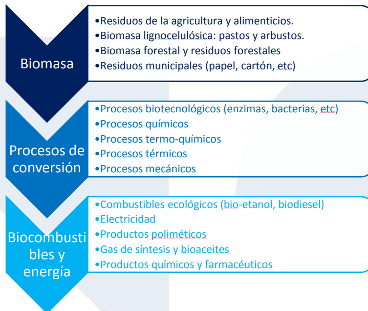
Figura 12. Principio de una biorrefinería de tercera generación. Tomado de (Kamm, Gruber and Kamm, 2010).
