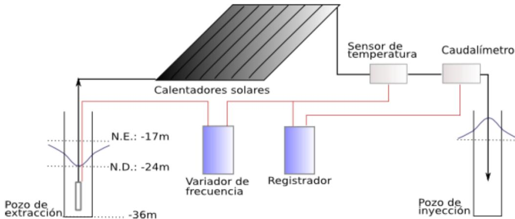
Figura 2. Esquema de la instalación.
