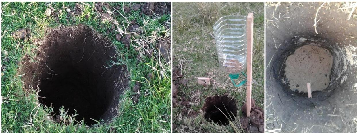
Figura 2. Fotografías del ensayo de infiltración realizado en campo.
