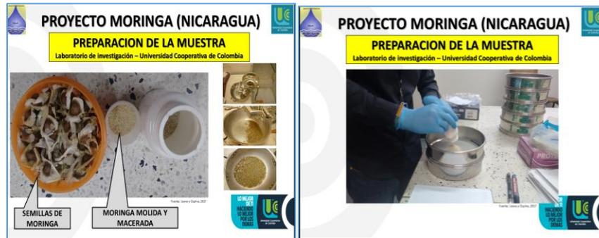
Figura 3. Preparación de la moringa como coagulante natural para proyecto AQUA
