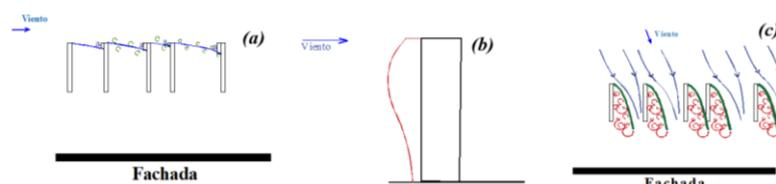
Ilustración 3. Flujo del viento paralelo a la fachada del edificio (a); Distribución de la presión del viento sobre la fachada de un edificio debido a la interacción con el viento (b); Flujo de viento perpendicular a la fachada del edificio (c).
