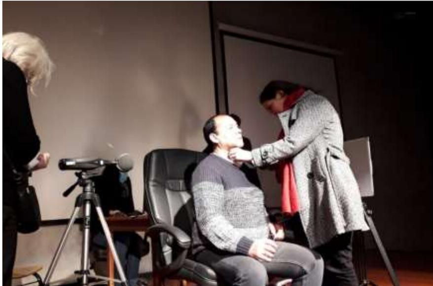
**Figura 6.3.2: Colocación del sensor: una de las fonoaudiólogas del equipo coloca el acelerómetro en un punto de medición (laringe) en el cantante tenor. A la izquierda de la foto se observa el sonómetro.**
