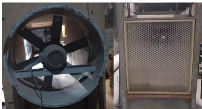
Figura 1. Ventilador (izquierda) y enderezador de flujo (derecha).
