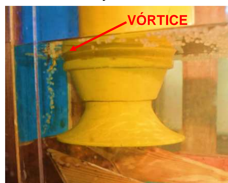
Fig.2- Visualización de vórtice en el estado original. (nivel -1,5).
