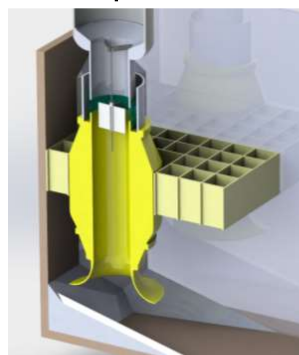
Fig.3- Alternativa rejilla con esquema de rotámetro.
