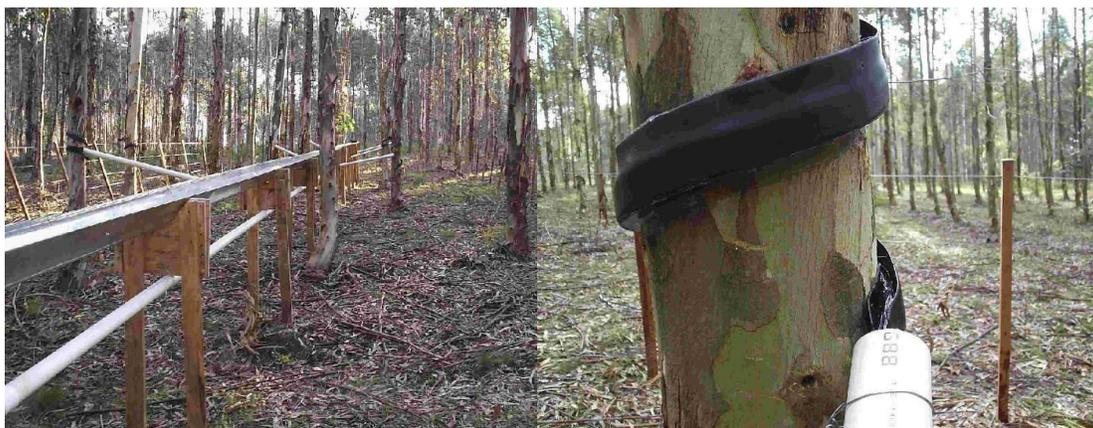
**Figura 3.-** Instalaciones para la medición de precipitación directa y fustal
