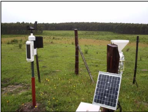
Figura 2.- a. Detalle del muestreo de agua de lluvia en un claro del monte de Eucalyptus dominado por pasturas naturales b. Vista de los dispositivos para medición de redistribución de lluvias y muestreo de aguas en la microcuenca forestal.
