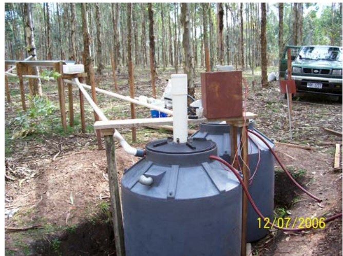
Figura 2.- a. Detalle del muestreo de agua de lluvia en un claro del monte de Eucalyptus dominado por pasturas naturales b. Vista de los dispositivos para medición de redistribución de lluvias y muestreo de aguas en la microcuenca forestal.
