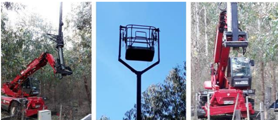
Figura 3.5.5: Elevador con brazo telescópico (Manitou) para acceder a las copas durante la medición de potencial hídrico foliar ( \Psi_w ) y conductancia estomática (gs).
