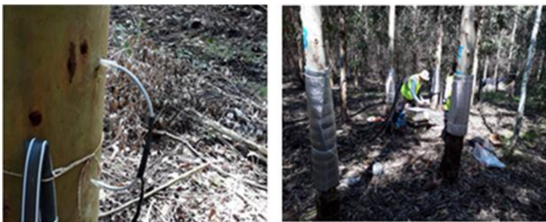
Figura 3.5.6: Vista de sensor flujo savia en leño conductor (Izquierda) y parcela de medición (derecha). Se observa el protector solar para evitar calentamiento.
