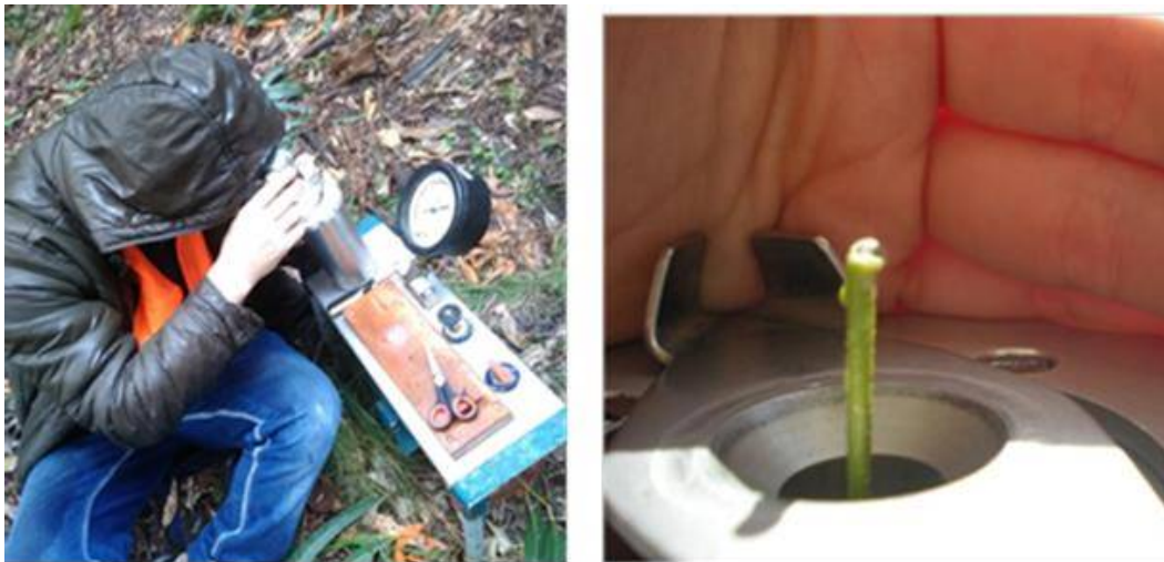
Figura 3.5.4: Medición del potencial hídrico foliar con cámara de presión a partir de muestras colectada en el tercio superior de copa.
