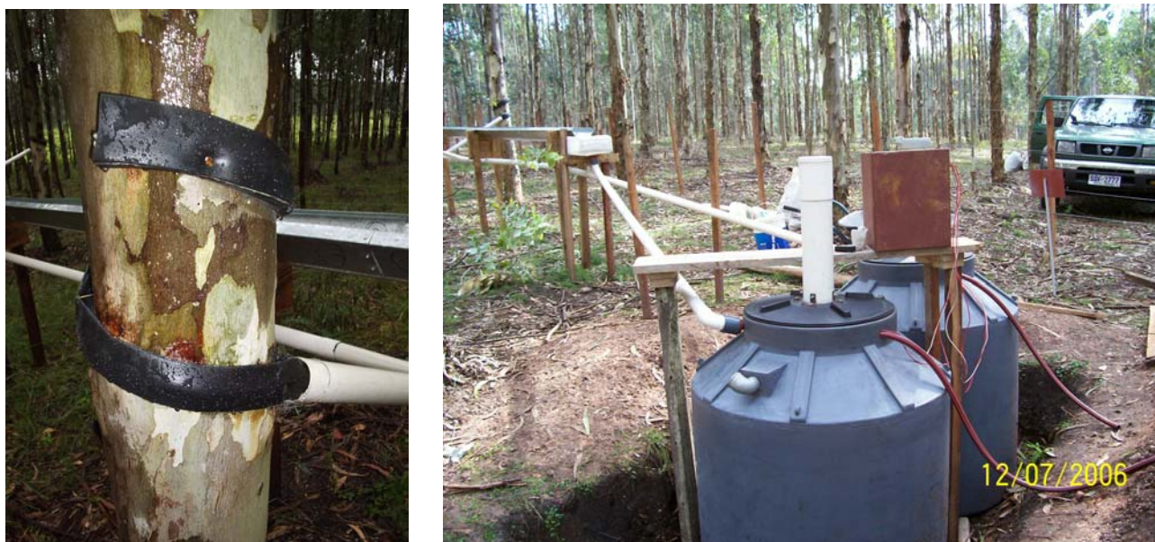
Figura 1.- a (izquierda). Dispositivo para medición del escurrimiento fustal, b (derecha). Vista de la canaleta para medición de la precipitación directa y cisternas en las que se efectúa el registro.
