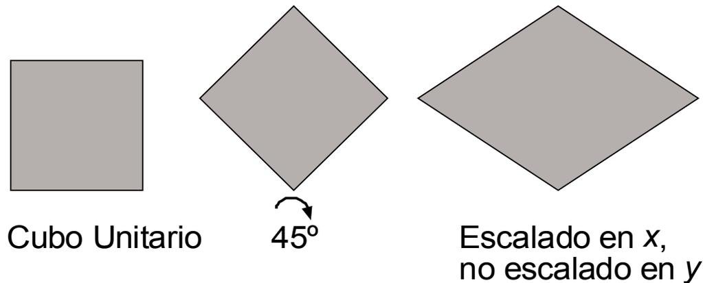
Un cubo unitario rotado  $45^\circ$  en sentido horario y luego escalado no uniformemente. El resultado es una transformación afín de la figura inicial, donde se mantiene el paralelismo de las líneas, pero no las longitudes ni ángulos originales.
