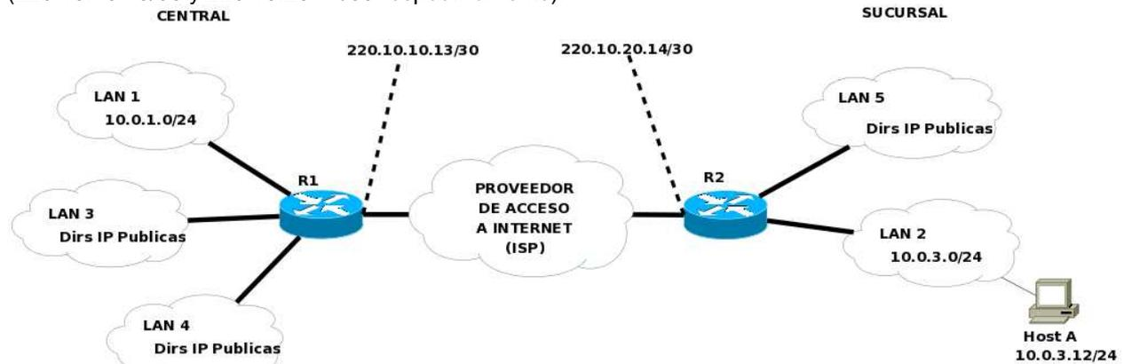
Las subredes LAN1 y LAN2 tienen direccionamiento privado y permanecerán sin cambios. Para expandir la red corporativa se ha adquirido el prefijo 147.10.8.0/21, con el cual se numerarán las subredes LAN3, LAN4 y LAN5, con perspectivas de seguir agregando subredes en el futuro. Los dos routers R1 y R2 tienen capacidad para realizar tunneling (IP en IP) y NAT.
