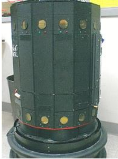
Figura 13: Ejemplo de anillos de sonares redundantes[8]
