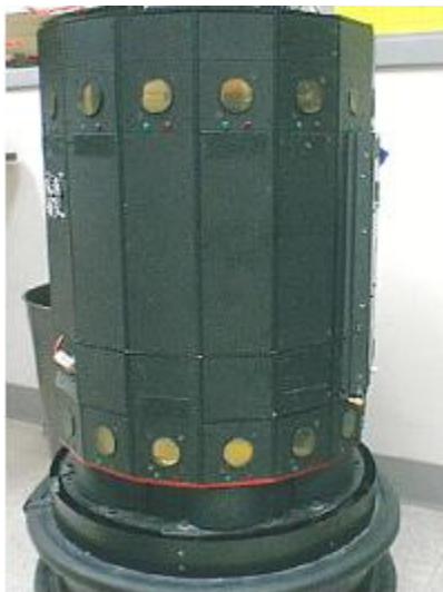
Figura 6: Ejemplo de anillos de sonares redundantes[5]
