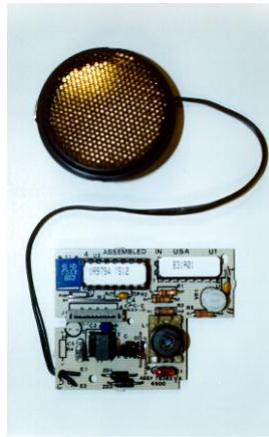
Figura 4: Transductor ultrasónico Polaroid[5]
