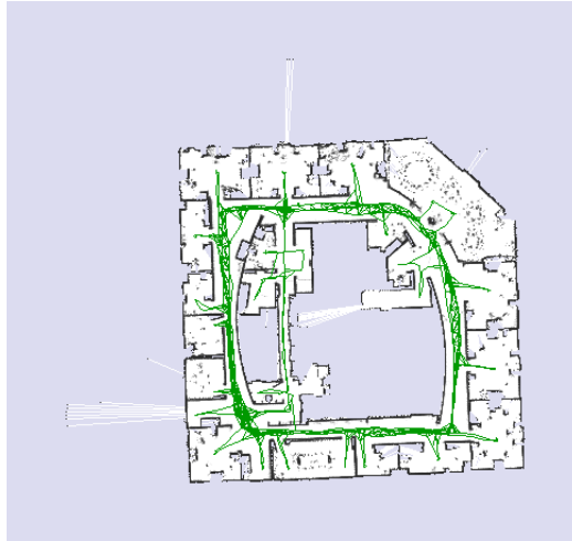
Figura 2.5: Mapa generado utilizando grillas de ocupación. Extraída de http://kaspar.informatik.uni-freiburg.de/ .
