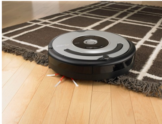
Figura 1.5: Imagen de un robot utilizado para limpieza doméstica subiendo una alfombra. Caso típico de quedar con una rueda en el aire o patinar. Imagen extraída de Wordpress.com.
