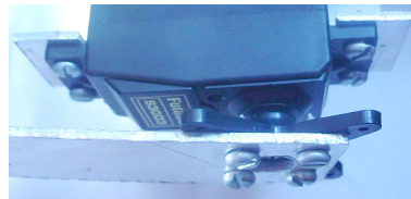
Figura 5.2: Fijación del eje y de la carcasa del servo
