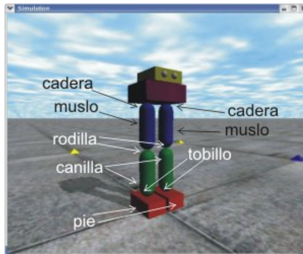
Figura 3.2: Esquema mecánico del prototipo
