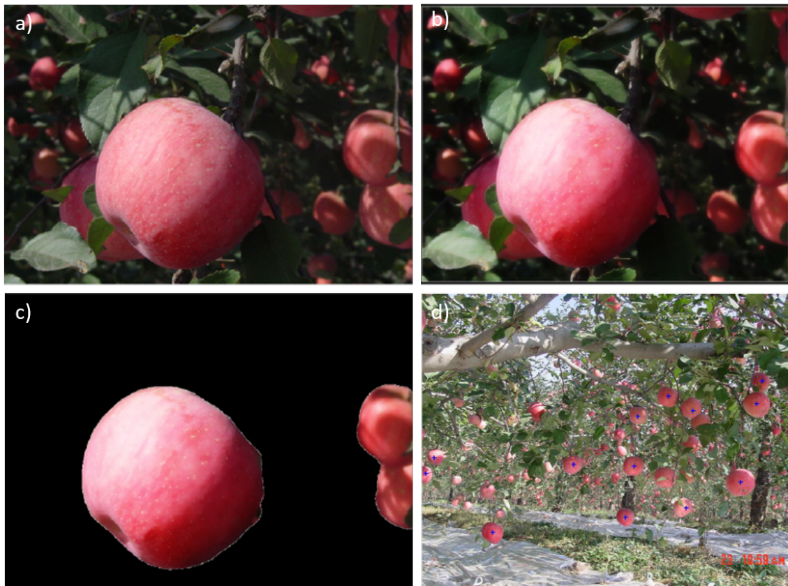
Figura 1.2: Imágenes de las técnicas utilizadas por Wei Ji et al. [15] a) Imagen original b) Imagen luego de filtrada c) Imagen luego de aplicar operaciones morfológicas y segmentación d) Imagen resultado
