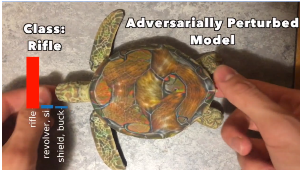
Figura 3.5: Captura de vídeo mostrando como la impresión 3D de una tortuga con una perturbación adversaria logra ser clasificada como rifle con alta certeza [25]
