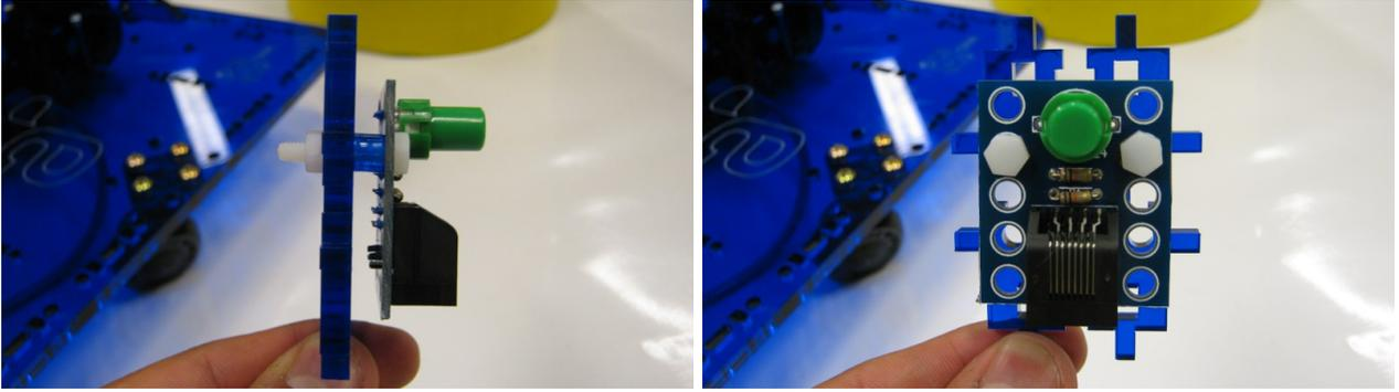
Luego montar la placa con el sensor en la barra de encastre Butiá como muestra la figura.
