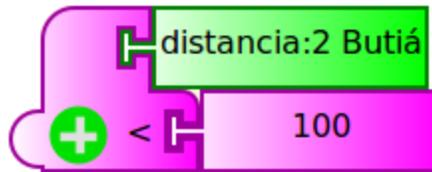
Los bloques de sensor que nos devuelven un rango de valores (en el ejemplo el sensor de Distancia) los comparamos con los bloques de menor o mayor ya que es muy difícil que nos devuelvan exactamente el mismo valor. En el ejemplo, nos va a devolver Verdadero si el valor retornado por el sensor de distancia es menor a 100, Falso en otro caso.
