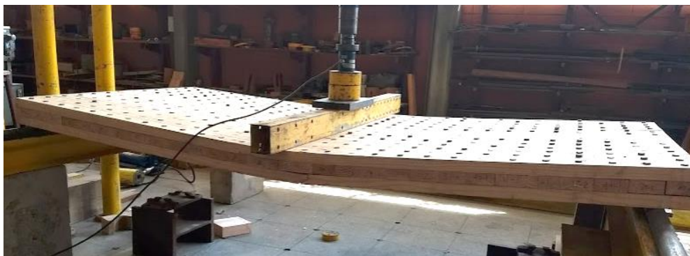
Figura 5: Painel DCLT após ruptura por tração
