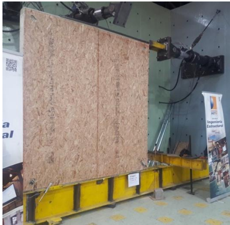
Figura 1: Disposición del ensayo y resultados monotónicos y cíclicos para muros de 2400 mm.
