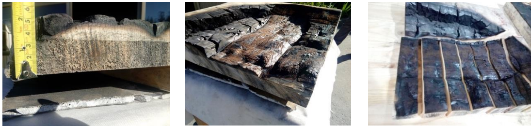
Figura 8: Medición de la capa carbonizada y resistente para MN2018.
