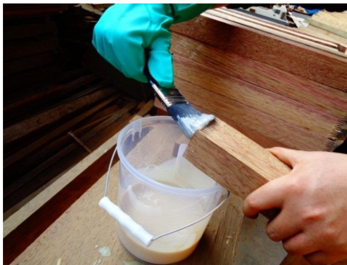
Figura 3: Encolado de piezas dentadas
