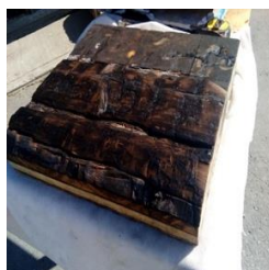
Figura 9: Medición de la capa carbonizada y resistente para LN2018
