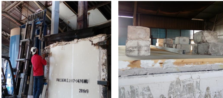
Figura 1: Sistema de aplicación de carga para muros y losas.
