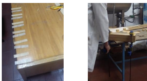
Figura 4: Fabricación y prensado de las probetas
