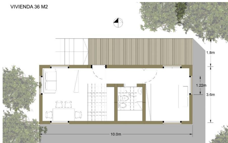
Figura 3a: Módulo vivienda- Planta
