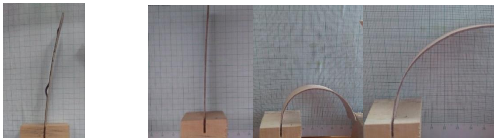
Figura 3: Delaminación (izq.) e incapacidad para recuperar la condición inicial (der.)
