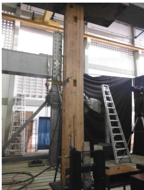
Figura 13. Elemento portante al inicio del ensayo.
