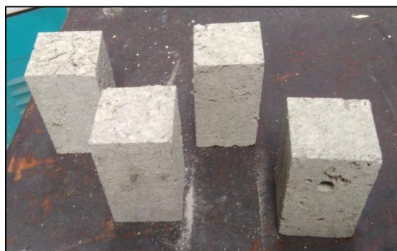
Figura 5: Bloque de ligno celulosa. (Villanueva 2017)
