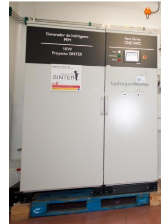
FUENTE: CNH2 – Electrolizador PEM 1kW HydrogenWorks (proyecto SINTER)
