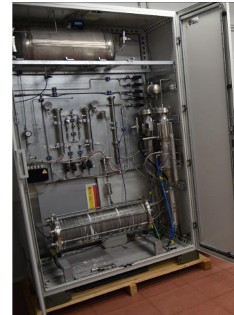
FUENTE: CNH2 – Electrolizador alcalino 5kW NITIDOR (proyecto SINTER)
