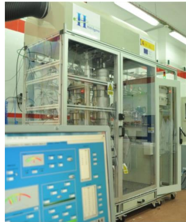
FUENTE: CNH2 – Banco de ensayos electrólisis alcalina 15kW (Laboratorio Electrólisis Alcalina)
