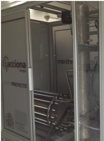
FUENTE: CNH2 – Electrolizador alcalino 100kW (proyecto DESPHEGA)
