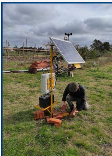
*Instalación de estación meteorológica en la zona de viviendas monitoreadas.*
