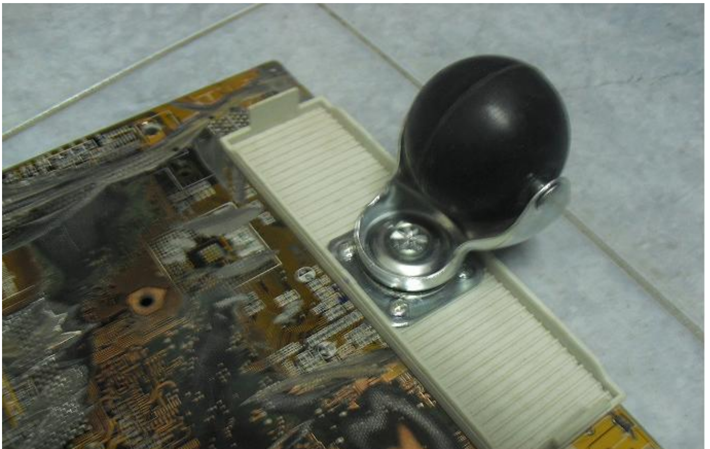
Rueda Loca económica. (T.Inglesa), reforzada con una tapa de bahía de CD, de una torre de PC. Todo el conjunto soporta el peso de una Notebook
