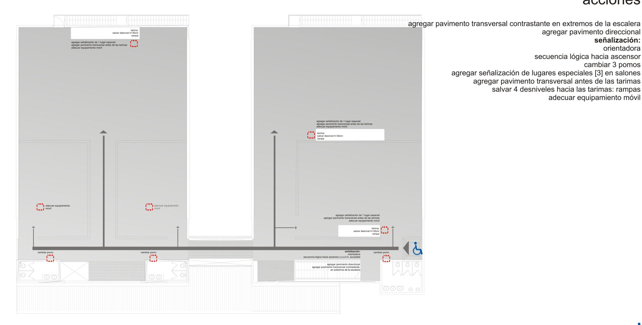
agregar pavimento direccional señalización: orientadora secuencia lógica hacia ascensor cambiar 3 pomos agregar señalización de lugares especiales [3] en salones agregar pavimento transversal antes de las tarimas salvar 4 desniveles hacia las tarimas: rampas adecuar equipamiento móvil
