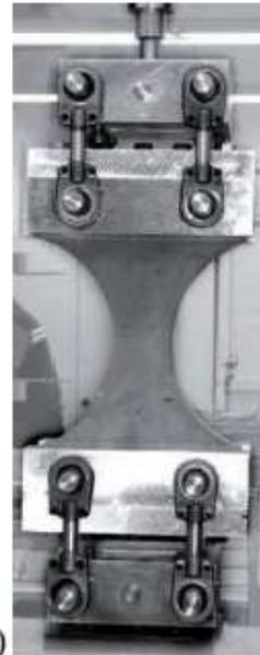
Diferentes configuraciones de ensayo a tracción uniaxial:
