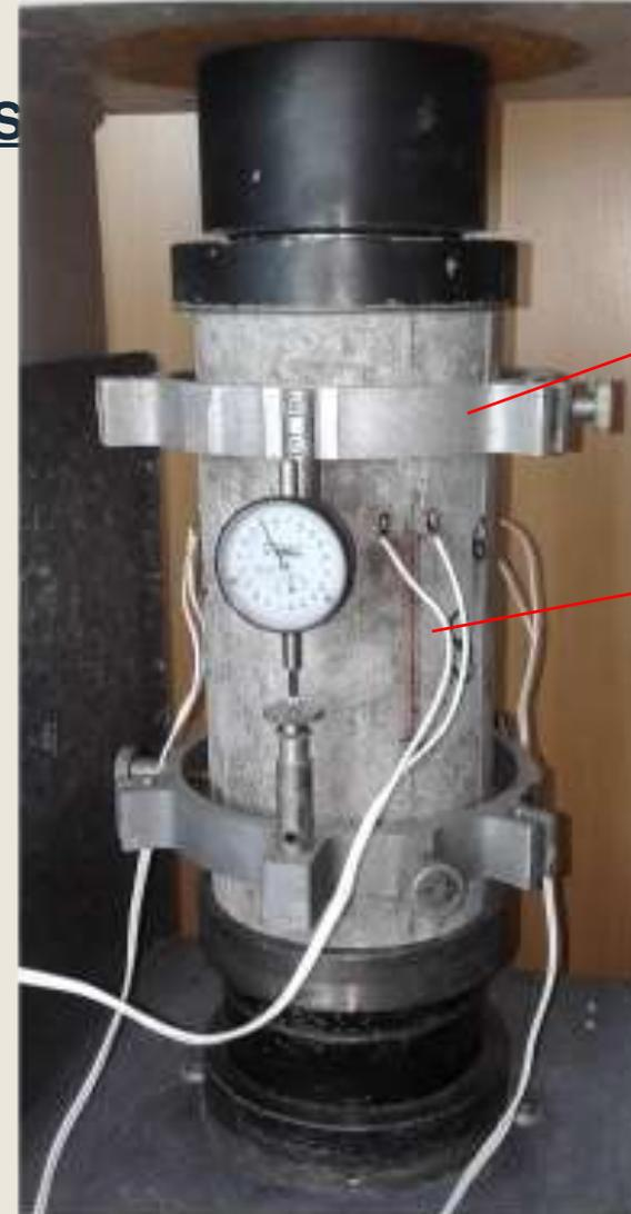
Sistema de anillos rígidos con un único compresímetro mecánico
