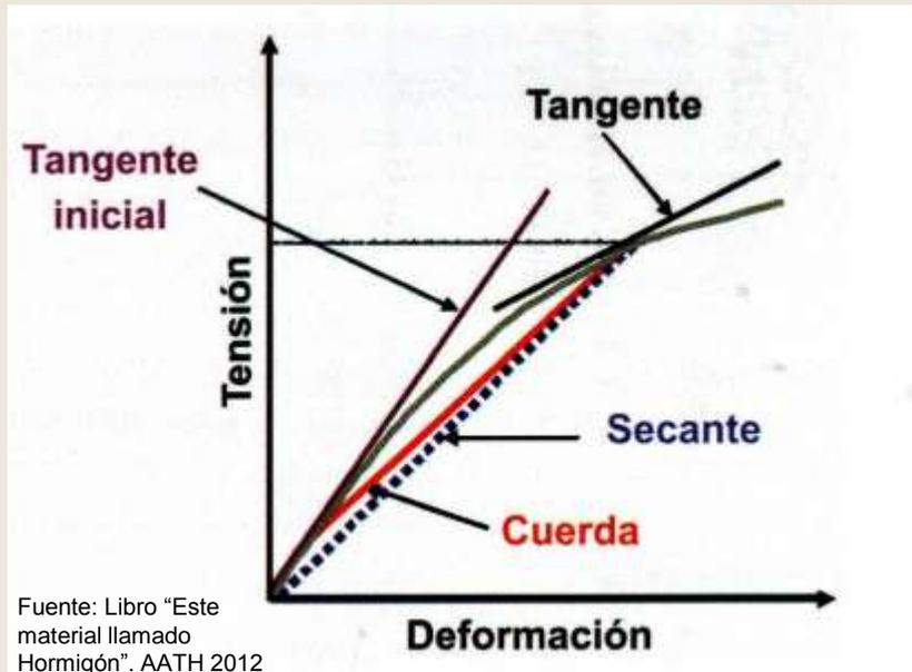
Las normas definen el módulo tangente inicial (dinámico) y el módulo secante, a partir de la pendiente de la cuerda, que abarca un tramo inicial de esfuerzos. (Si el hormigón trabaja dentro de este intervalo se supone elástico)
