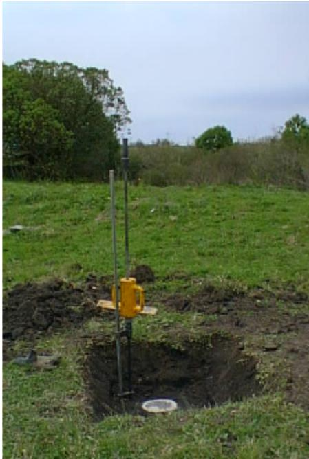
Figura 6 - Ejecución de un DCPT en Montevideo A.
