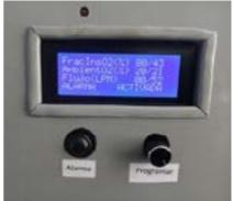
Observación: Al abrir y cerrar las válvulas se ve el cambio en la pantalla en el Flujo (LPM) como de Fracción de Oxígeno FracIns $O_2$  (%).
