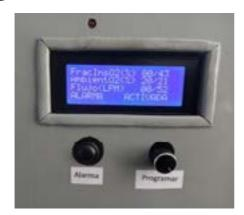
3 Se **debe** regular la presión de oxígeno y aire a **0.5 kg/cm²** utilizando los manoreductores de la instalación existente en el centro de salud, generalmente ubicada en la pared.
