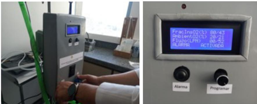
Observación: Al abrir y cerrar las válvulas se ve el cambio en la pantalla en el Flujo (LPM) como de Fracción de Oxígeno FracInsO<sub>2</sub> (%).
