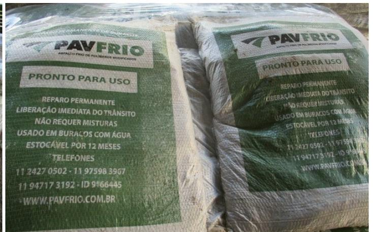
El bacheo se realizó con pavimento asfáltico frío para minimizar el tiempo entre la reparación y el uso del estacionamiento. Los trabajos fueron realizados durante el feriado de carnaval.
