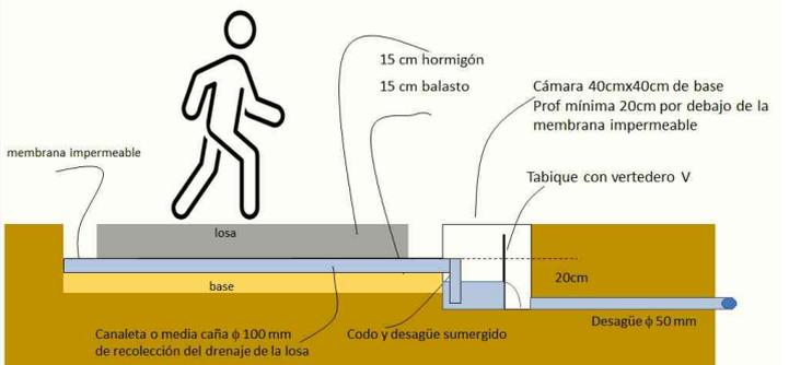
Posteriormente al hormigonado se realizarán trabajos complementarios como la construcción de una cámara, desagües, y acondicionamiento del terreno.
