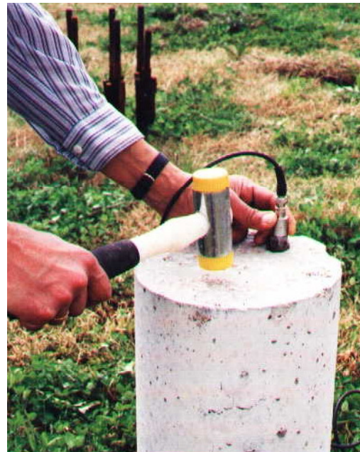
Foto1 Ensayo de integridad de pilotes.
