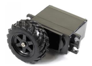
Como su nombre indica, los servos de rotación continua **son capaces de dar la vuelta completa**, comportándose de forma similar a un motor DC, con control de velocidad integrado. A cambio perdemos el control de posición, por lo que si queremos controlarla deberemos añadir un encoder.
