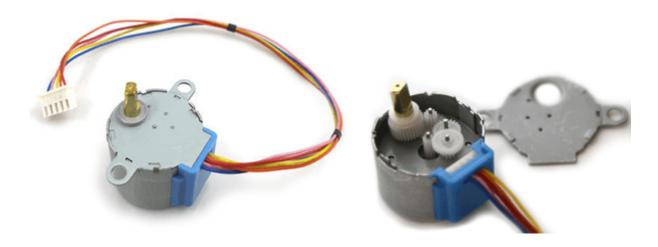
Esto significa que la precisión global es de menos de 0,087° (4096 pasos) y un par de 0,3kg/cm. Puede operar a una frecuencia máxima de 100Hz, por lo que la velocidad máxima es de 1 vuelta cada 40 segundos.
