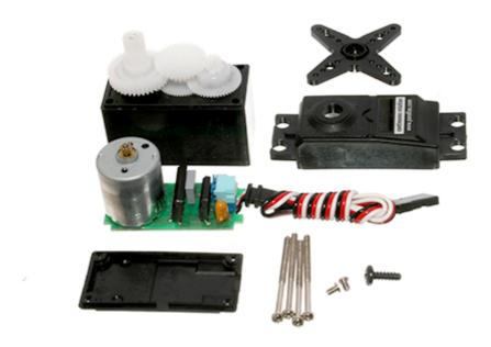
Los servos son ampliamente utilizados en proyectos de robótica, como brazos robóticos, hexápodos, o robots bípedos. También pueden usarse en torretas, o para posicionar un sensor,
