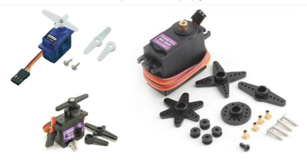
Un servo **no puede dar una vuelta completa**, siendo su rango habitual de 180°. A cambio, proporcionan un **control total en posición y giro y de una alta precisión**, y son muy sencillos de usar.
