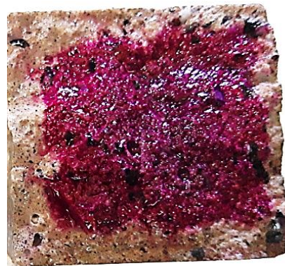
Figura 1 – Reacción del mortero ante la solución con fenolftaleína
