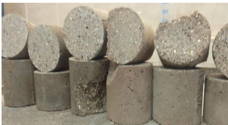
Figura 1 – Probetas Cilíndricas - High Alumina Mortar
