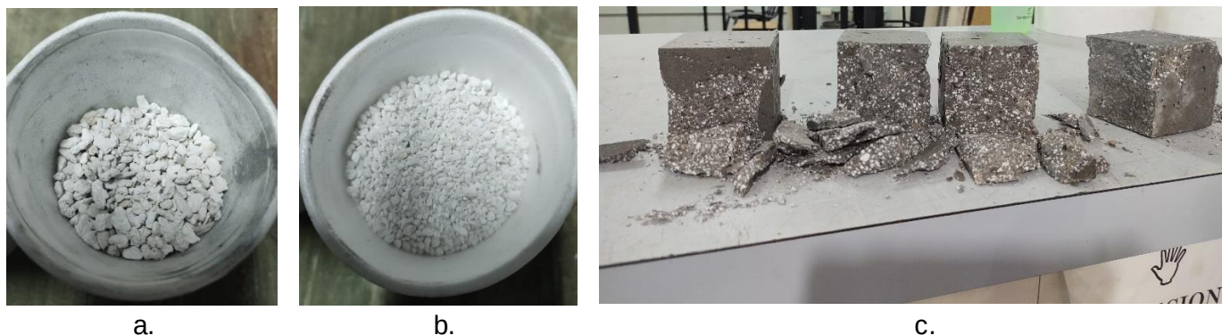
Figura 1 – a. Perlita volcánica, b. Perlita expandida, c. Probetas cúbicas ensayadas a compresión
