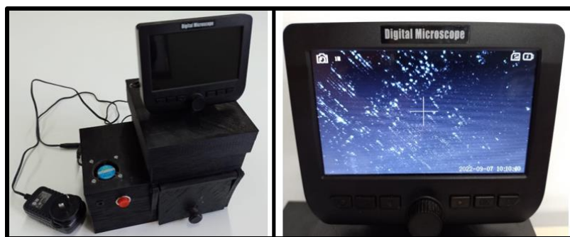
Figura 1 – Prototipo empleado en el ensayo de speckle dinámico
