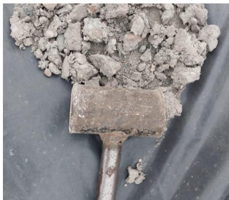
Figura 2 – Obtención mecánica del AGR
