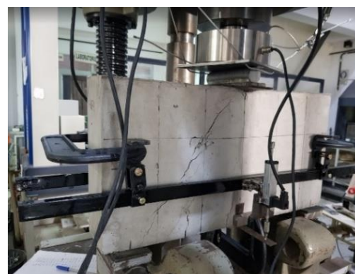
Figura 1 – Instrumentación del ensayo a flexión de las VGA
