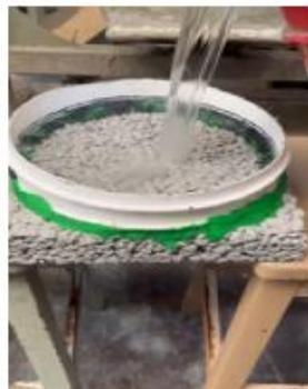
Hormigón drenante modificado con  $\text{TiO}_2$
