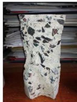
Hormigón denso modificado con  $\text{TiO}_2$
