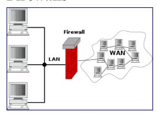
Esquema de una red de computadoras que utiliza un Cortafuegos.
